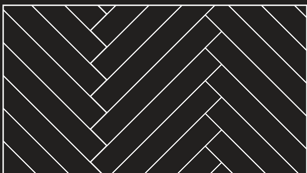
Visgraatverband En chevrons / Fischgratverband / Visgraat arrangement
