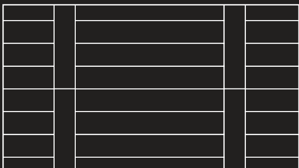
Ladderverband Pose en échelle / Leiterverband / Ladder pattern
